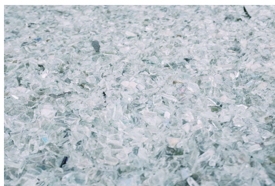
Thủy tinh phế thải được nghiền thành bột để trộn vào gạch đất nén.
