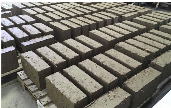
Các khối gạch được trộn thủy tinh tái chế với tỷ lệ từ 0% đến 25%.
