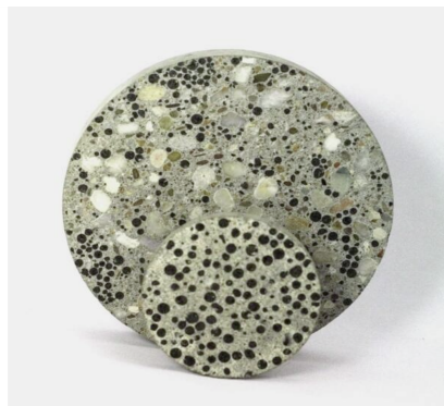
Bê tông tự phục hồi sử dụng vi khuẩn có thể lấp đầy các vết nứt trong bê tông bằng cách tạo ra kết tủa canxi cacbonat thông qua quá trình khoáng hóa sinh học.
