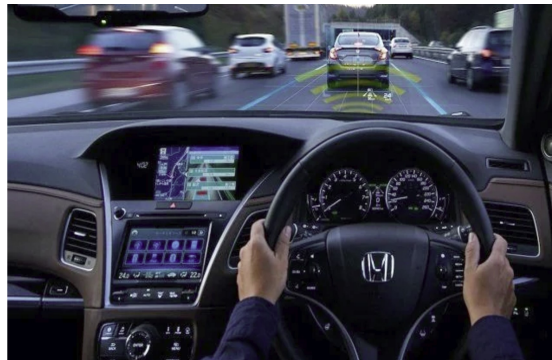
Đức phát triển hệ thống hỗ trợ lái xe tự động (ADAS), bao gồm cảnh báo nguy hiểm, phanh tự động và hỗ trợ giữ làn đường.
