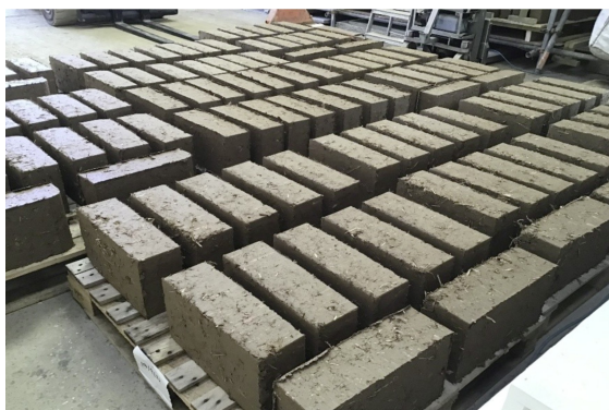
Gạch đất nện (CEB) là vật liệu xây dựng tự nhiên không cháy, không mục nát và không lãng phí năng lượng trong điều kiện khí hậu nóng hoặc lạnh.
