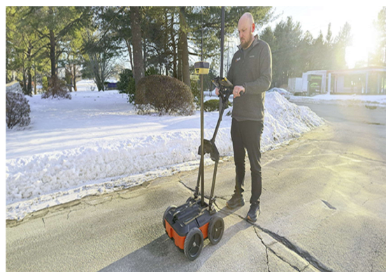
Sử dụng GNSS và radar xuyên đất để xác định hạ tầng ngầm.
