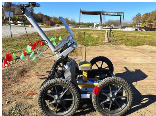
Sử dụng công nghệ radar xác định vị trí và hình dạng các đường ống ngầm.
